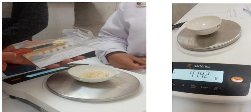
Nota: Pesaje de la muestra pino (a) y pesaje de crisol (b)
